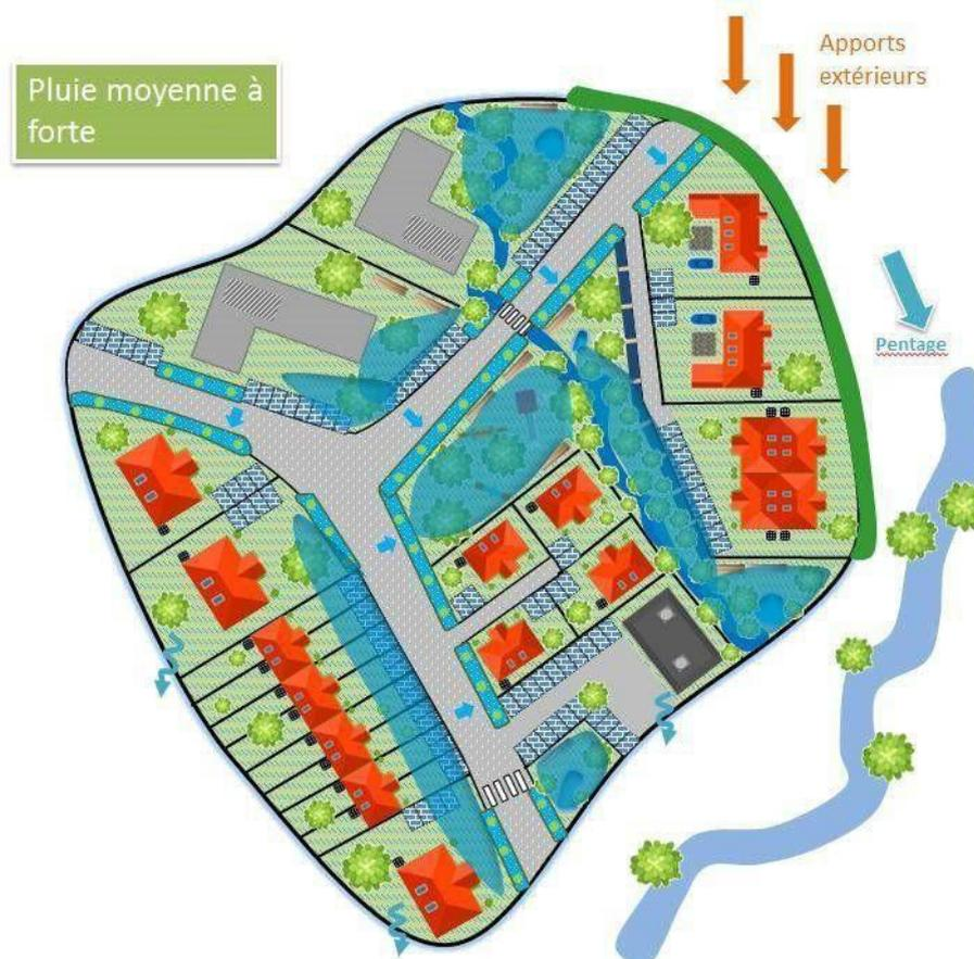
Par application de la méthode des pluies, on obtient un volume maximal à stocker pour la surface totale du projet de **1004 m<sup>3</sup>**. La pluie dimensionnante est dans notre exemple la pluie de **durée 25 minutes pour le cas 1 et la pluie de durée 32 h pour le cas 2**.
