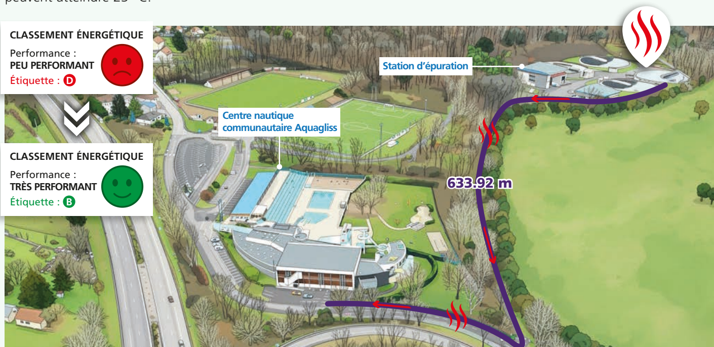
Représentation schématique de la récupération de la chaleur de la station d'épuration pour chauffer l'eau des bassins Aquagliss
